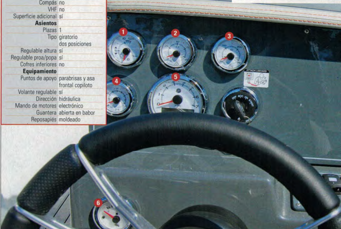
1. Trim | 2. Presión aceite | 3. Temperatura | 4. Voltímetro | 5. Cuentarrevoluciones multifunción | 6. Nivel combustible
